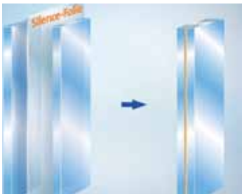
Unsere Schallschutzscheiben sind mit einer speziellen Akustik-Folie ausgestattet.
